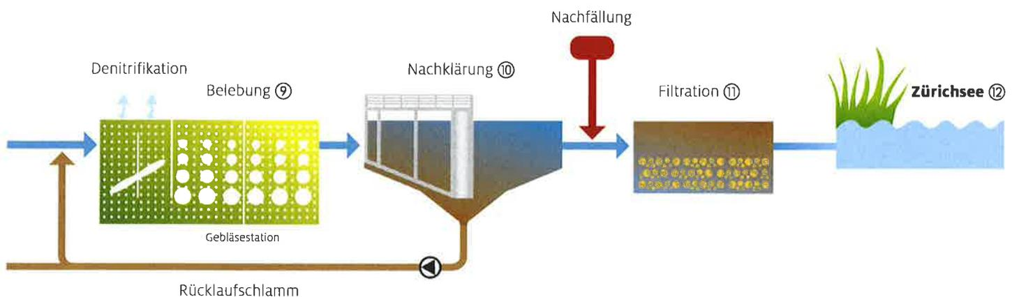
Mit der erfolgten Sanierung wurde eine zweite Stufe in den biologischen Reinigungsprozess integriert: Die Denitrifikation. Bei diesem Vorgang wird der Stickstoff-Abbauprozess fortgesetzt und das Nitrat zu molekularem Stickstoff umgebaut. Dieser Prozess findet nur statt, wenn kein gelöster Sauerstoff im Becken vorhanden ist. Um die Mikroorganismen in Schwebelage zu halten, wird der Belebtschlamm mit einem Rührwerk umgewälzt.
