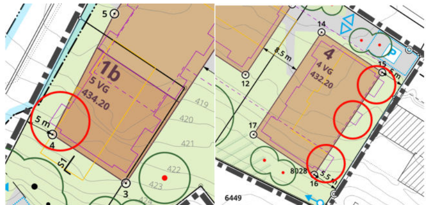
Maximal 2.0 m über Baubereich vorspringender Gebäudeteil (roter Kreis)
